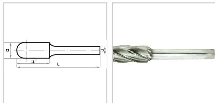
Rotorfräser werden bis einschließlich Kopfdurchmesser 6 mm aus Vollhartmetall gefertigt, ab Kopfdurchmesser 8 mm wird der Hartmetall-Fräskopf auf einen Stahlschaft aufgelötet, Alu-Cut, gute Spanabfuhr durch positiven Spanwinkel und verrundeten Zahngrund, auch bei schmierenden Werkstoffen kein Zusetzen, ruhiger Lauf durch Schälwirkung der Zahnung, hohe Oberflächengüte
