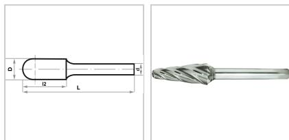
Rotorfräser werden bis einschließlich Kopfdurchmesser 6 mm aus Vollhartmetall gefertigt, ab Kopfdurchmesser 8 mm wird der Hartmetall-Fräskopf auf einen Stahlschaft aufgelötet, Alu-Cut, gute Spanabfuhr durch positiven Spanwinkel und verrundeten Zahngrund, auch bei schmierenden Werkstoffen kein Zusetzen, ruhiger Lauf durch Schälwirkung der Zahnung, hohe Oberflächengüte
