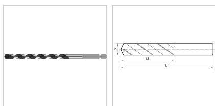
hält 2x länger als ein Bosch "CYL-3 Bohrer", mit Sechskantschaft für eine starke Verbindung und maximale Drehmomentübertragung in Dreibackenfuttern und 1/4" Werkzeughaltern, Spitze mit durchgehender Carbide-Schneide
