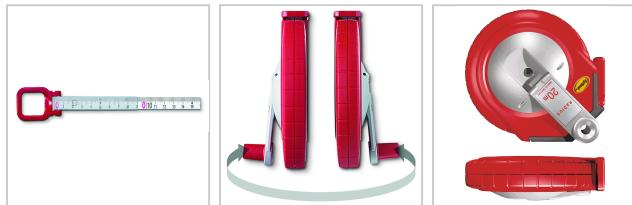
ergonomisches Gehäuse, großer Kurbelarm, Parkposition für den Anfangsring, Gleitlagerschalen für optimalen Wickelkomfort, griffsympatischer Soft-Touchoberfläche, Maßanfang ca. 10 cm nach Anfangsbeschlag~Band aus glasfaserverstärktem Kunststoff mit gedruckter Teilung, cm-Teilung an Oberkante in schwarz, Meter-Vorzahlen in rot~1, alle BMI Kapselbandmaße mit metrischer Teilung haben eine EG-Bauartzulassung
