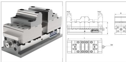
vergüteter Werkzeugstahl, oberflächengehärtet, Funktionsflächen präzisionsgeschliffen, gehärtete Spindel (Ausführung E), gehärtete Spindel und geschliffene Spindel (Ausführung S), eingeschliffene Grundbacken, massive, verwindungssteife und vollgekapselte Bauweise, Zentriergenauigkeit  $\pm 0,015$  mm (Ausführung E),  $\pm 0,005$  mm (Ausführung S), Wiederholgenauigkeit 0,01 mm (Ausführung E),  $\pm 0,003$  mm (Ausführung S), Paarungsgenauigkeit 0,01 mm, Lieferung ohne Spannbacken
