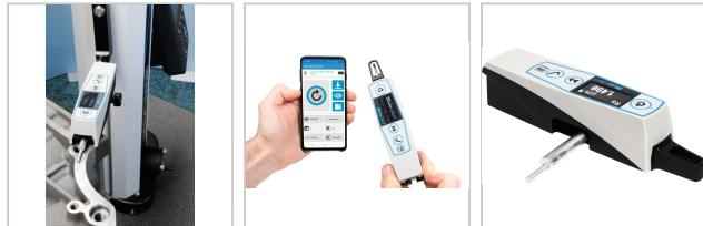
kompakt, tragbares Messgerät, mit jedem Messstativ kompatibel, vereinfachte Ergonomie mit 3 Tasten auf der Oberseite gestattet eine einfache Darstellung der Messparameter, die Anpassung der Toleranzen und das Starten der Messung, Ausrichtung 90° des Messtasters für Quermessungen möglich, Messkraft 0,75 mN, Stromversorgung erfolgt über integrierten Ni-MH-Akku 2,4 V/0,75 Ah
