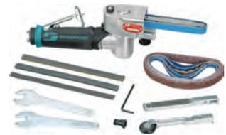
Kleines Gehäuse ermöglicht Arbeiten in engen Öffnungen, einstellbarer und austauschbarer Schleifarm, exakter Geradlauf, schneller und einfacher Schleifbandwechsel, Schleifbandkühlung über Abluft
