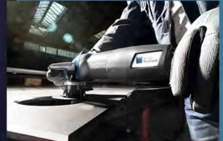
Ob ein Kantenfräser oder Schweißkantenformer die richtige Wahl ist, hängt primär vom Zweck der Kante ab. Während Kantenfräser als Multitalente gelten, die durch beste Oberflächenqualität überzeugen, haben Kantenformer vor allem eine Stärke: Sie erzeugen perfekte Schweißkanten mit bestem Preis-/Leistungsverhältnis.
