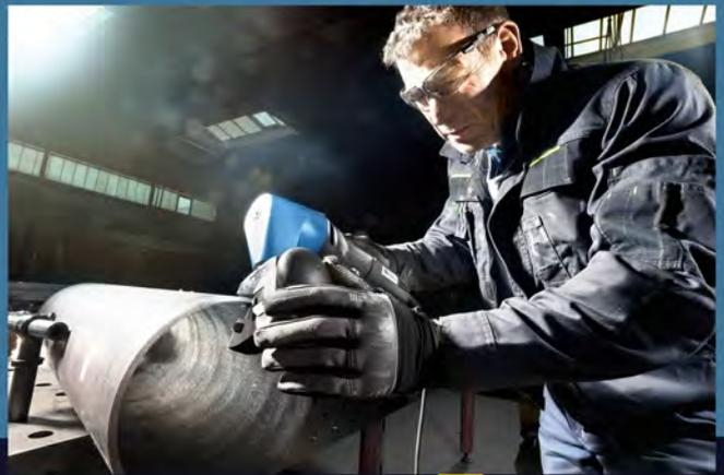
Ohne Rauch, Funkenflug oder Staub. Egal ob Sie eine Fase für die Schweißnaht, eine saubere Abschlusskante für Lackierbeschichtungen oder einen Radius anbringen wollen, hochwertige und oxidfreie Kanten sind der Schlüssel zum Erfolg! Trumpf bietet Lösungen, wie Sie diese einfach, schnell und ohne lästige Emissionen erstellen können.
