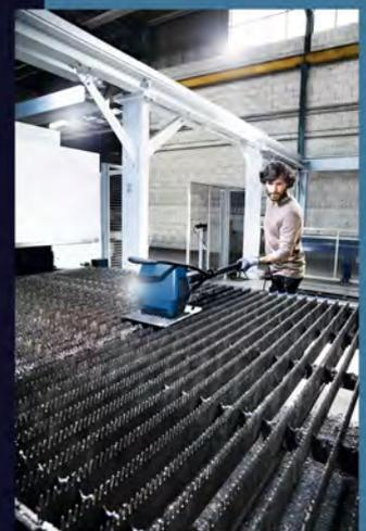
Die Auflageleisten-Reiniger ermöglichen Ihnen eine rasche und mühelose Reinigung Ihrer Auflageleisten. So ist eine prozesssichere und qualitativ hochwertige Fertigung der lasergeschnittenen Bauteile gewährleistet. Die Leisten müssen zur Reinigung nicht ausgebaut werden. Das ist praktisch und spart Ihnen Zeit.
