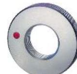
gehärtet, entspannt, Messflächen geschliffen und feinst geläppt
