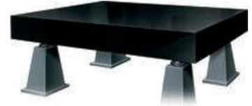
hochfest und äußerst homogen und feinporig, geringe thermische Ausdehnung, korrosionsfrei und von hoher mechanischer Festigkeit, Messflächen diamantgeläppt, Außenkanten sichtgeschliffen, Rückseite feingesägt
