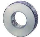
gehärtet, entspannt, Messflächen geschliffen und feinst geläppt
